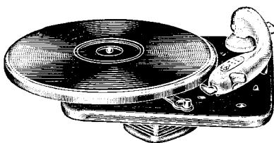
Motore tipo «PS1/B» monofase ad induzione. - Potenza assorbita 20 W. Cambio tensioni per 120-150-220 V. c.a. - Frequenza 50 p/s. - Senza regolatore di velocità. - Cambio di velocità a leva. - Piatto metallico da cm. 25. - Peso Kg. 3.000. - Ingombro: mm. 61 sopra la piastra, mm. 57 sotto la piastra. - Rivelatore tipo «Bellini» . . . . .
